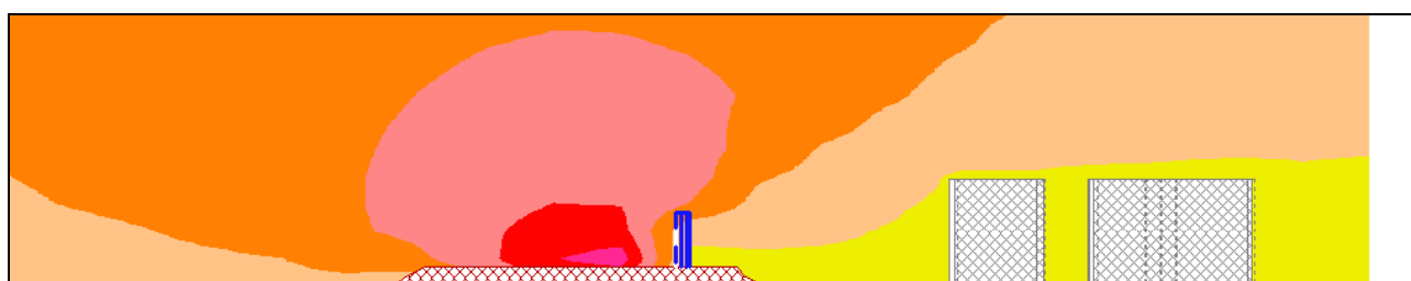
FIGURA 2.35. Griglia di calcolo di periodo notturno presso il recettore "Tav. 1 – Gruppo C", in presenza di barriera: si rileva il pieno rientro a norma in sezione
